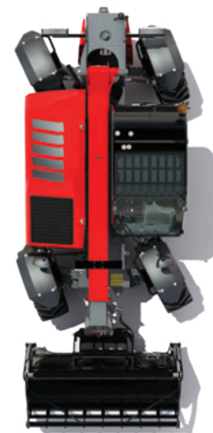
Tryb kierowania: „psi chód” — efektywne napędzanie i równanie oraz praca przy ścianach, w ograniczonych przestrzeniach.
