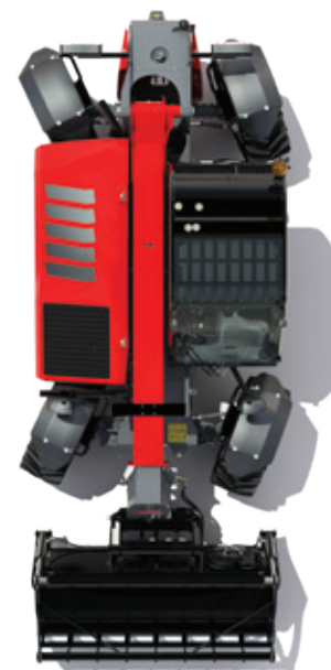
Tryb kierowania: dwie osie skrętne — minimalna średnica zawracania
