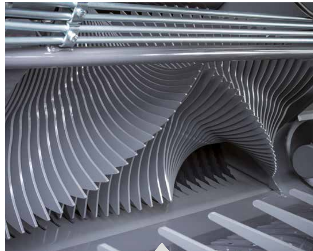
System tnący Xtracut 25 posiada 4-gwiazdzysty rotor dla wyższej wydajności.
